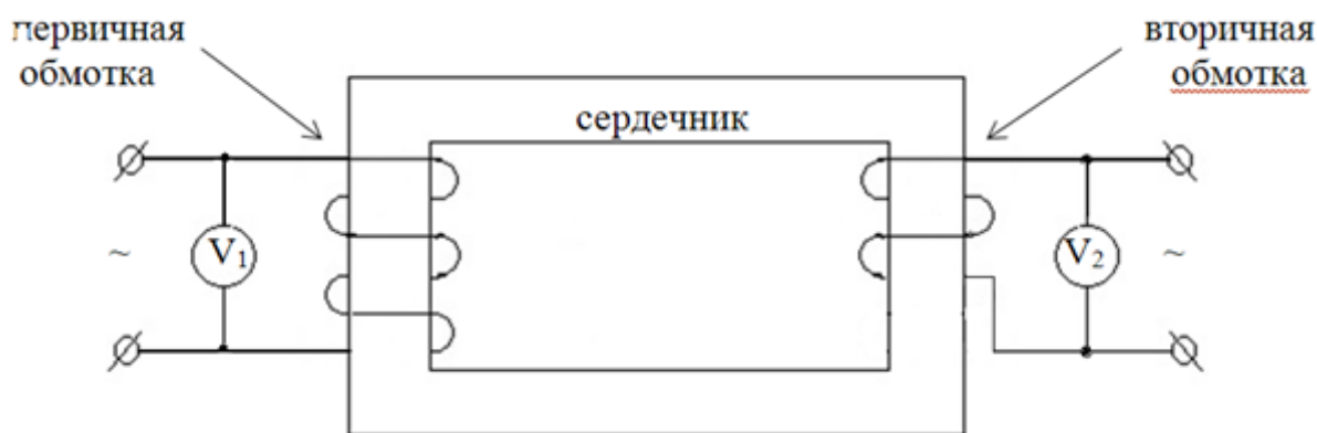
Рис. 27. Принципиальная схема простейшего трансформатора
