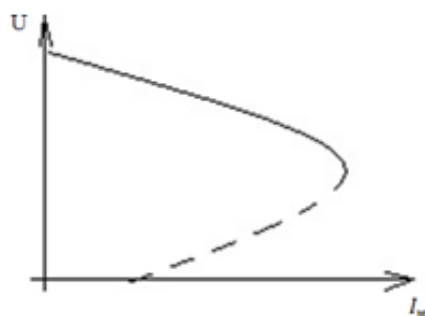
Рис. 16. Внешняя характеристика генератора с параллельным возбуждением
