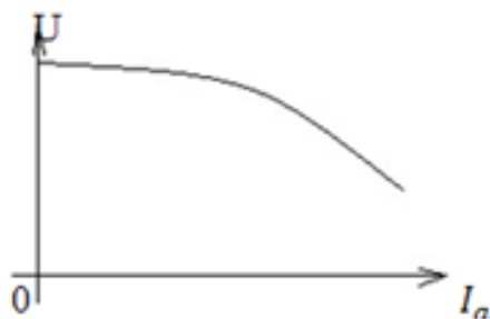
Рис.12. Внешняя характеристика генератора независимого возбуждения
