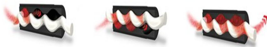
Рис. 20. Принцип действия винтового насоса.
