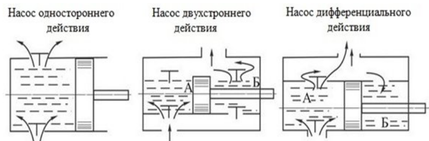
Рис. 27. Классификация насосов по числу действий.
