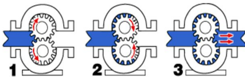
Рис.41. Принцип работы шестеренного насоса с внешним зацеплением
