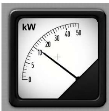
Рис. 8.2. Измерение мощности вентилятора с помощью стрелочного киловаттметра
