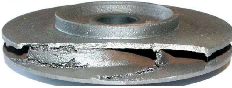
Рис. 7.1. Разрушение рабочих колес вследствие кавитации
