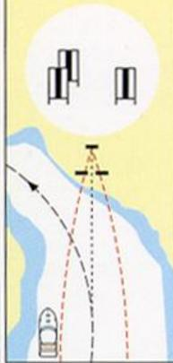
**Кромочный створ** обозначает положение судового хода и его кромок. Передние знаки прямоугольные, задние — трапециевидные. Одна кромка указывается двумя знаками, а для обеих кромок используется четыре знака (два передних и два задних).
