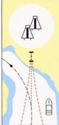
**Щелевой створ** обозначает положение судового хода и его кромки тремя знаками: два передних, один задний. Расположены они на вершинах равнобедренного треугольника. Два передних знака располагаются перпендикулярно к оси судового хода на равном расстоянии. Задний знак расположен на оси судового хода. Судно находится на судовом ходу, пока задний средний знак виден между передними.
