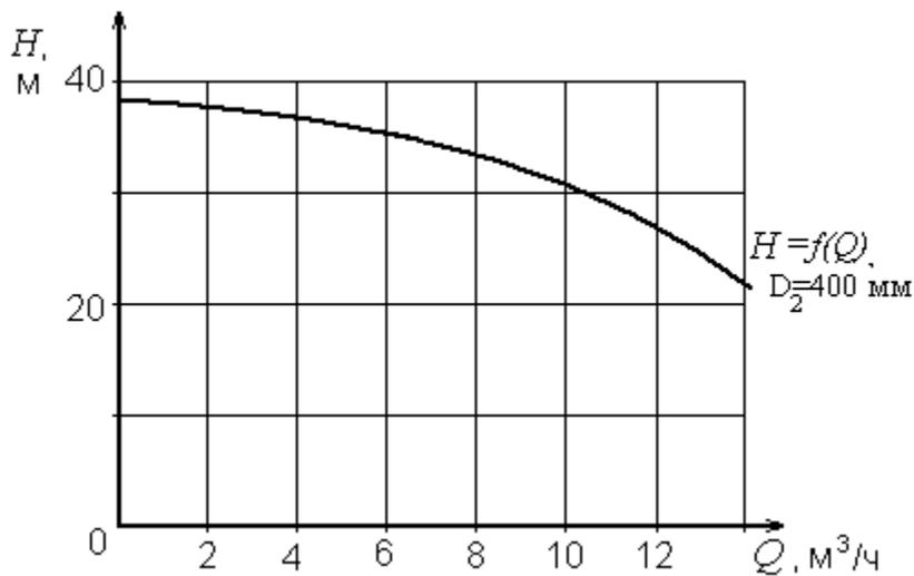
Определить наружный диаметр рабочего колеса центробежного насоса, обеспечивающий параметры  $Q=7\text{м}^3/\text{ч}$  и  $H=25 \text{ м}$ .
