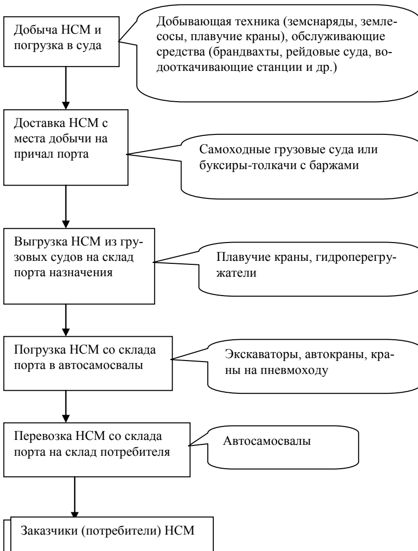
Рис. 2. Транспортно-логистическая цепь поставки НСМ на условиях доставки на склад получателя с проектными техническими средствами
