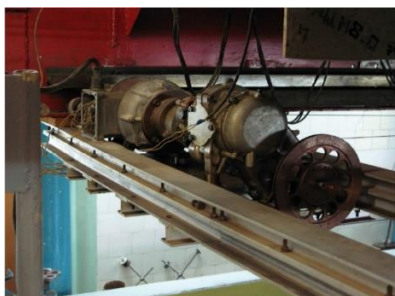
Рис. 4. Электромеханическая система буксировки моделей
