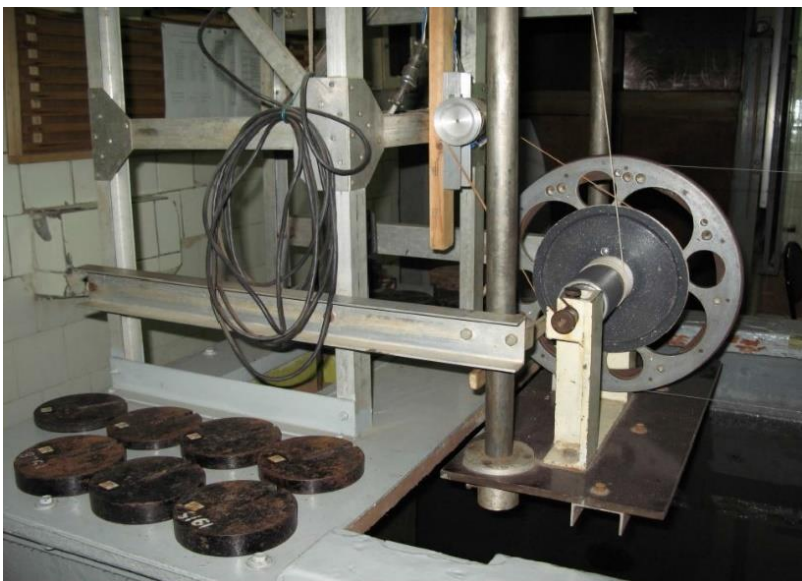
Рис. 3. Гравитационная система буксировки моделей
